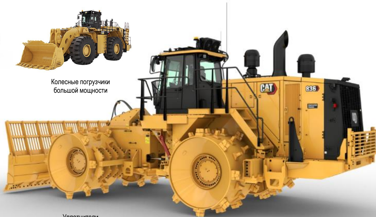
Уплотнители закладки отходов
