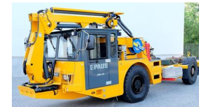
Машины со стрелой для механизированного зарядки шпуров и скважин (для навесного эмульсионного оборудования)
